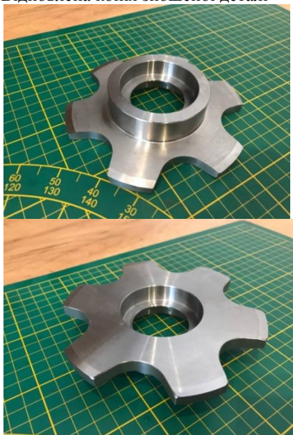
Рисунок 2 – Послідовність створення відновленої копії зношеної деталі
