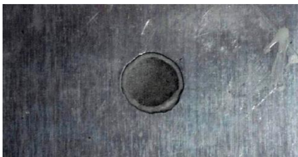
Рисунок 3 – Зовнішній вигляд штучного корозійного дефекту
